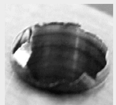
Grat am Austritt mit herkömmlichem Bohrer
